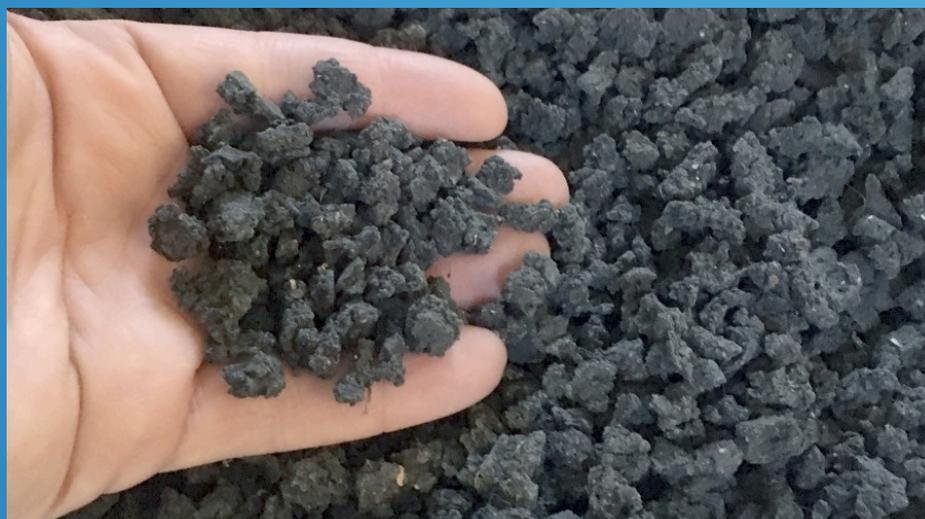
Fig. 3 : Fanghi disidratati scaricati dalla centrifuga
