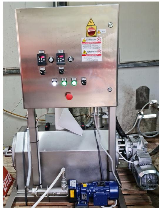
Il dispositivo è in grado di dosare e omogeneizzare vari tipi di prodotti chimici (coagulanti, flocculanti, ecc.), principalmente nei fanghi di depurazione provenienti da trattamenti aerobici e/o anaerobici civili e/o industriali, da disidratare.
